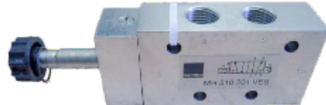
Alumínium szelep 720 óra után sópermet kamrában
