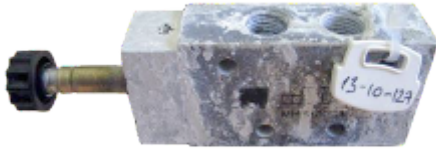
Rozsdamentes szelep 720 óra után sópermet kamrában
